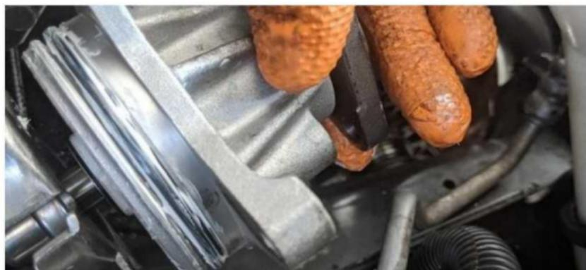
Para asegurarse de que la Bomba de Agua gire libremente, y absorba el refrigerante correctamente, debe girarla manualmente. Sin embargo, nunca debe hacerlo con las manos, ya que puede dañar la junta que hay dentro de la bomba y ocasionar un fallo prematuro de la bomba de agua. En lugar de sus manos, utilice una llave.
