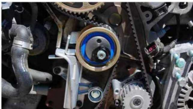
El Tensor de la banda es una pieza barata que es fácil de reemplazar. Cuando falla el Tensor de la Banda, la Banda de Distribución se rompe, ocasionando graves problemas. Por ejemplo, las válvulas se pueden doblar, la culata o el árbol
